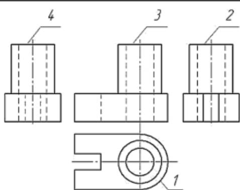
20 Опираясь на технический рисунок, можно сделать вывод, что фронтальный разрез детали обозначен цифрой ...
