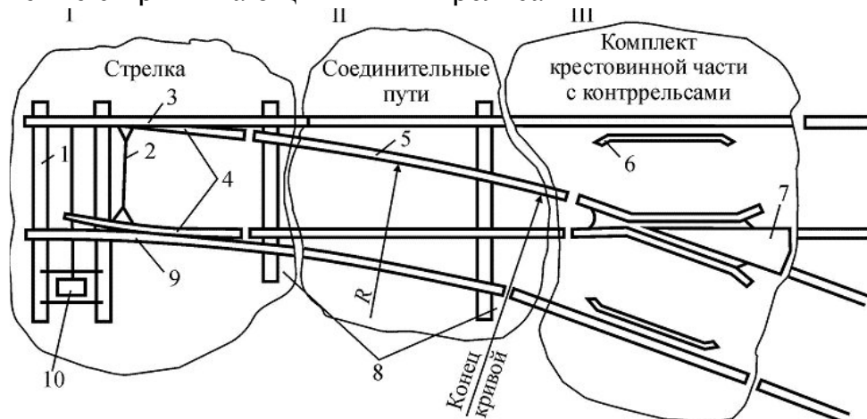
Рисунок 1 Обыкновенный одиночный стрелочный перевод
